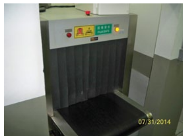
Esteira de inspeção de bagagem
